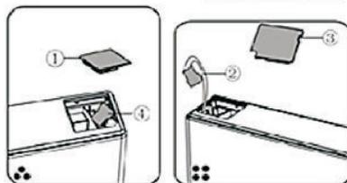
7. Desserrez la vis (3) et retirez les pièces (2). et (1), installez la butée de porte de remplacement à gauche (4) (fournie dans le sac en plastique) et la pièce (2) (bloc d'arrêt) sur le côté gauche à l'aide de la vis (3). Conservez la pièce (1) avec l'appareil pour référence ultérieure
